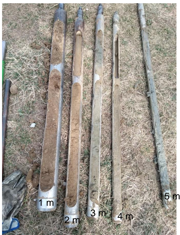
Foto 2. Sapele carotiere extrase din forajul 1
